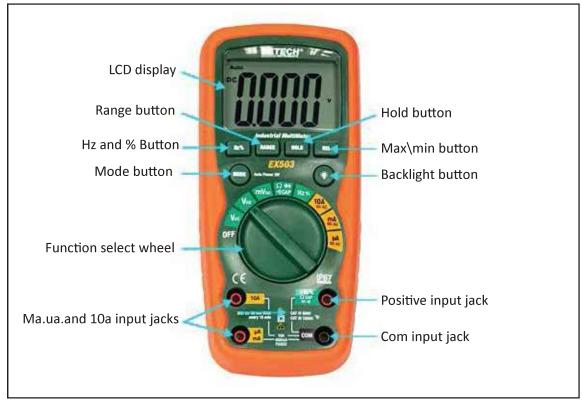
Fig: 1.4.10.1 Digital Multimeter
