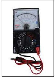
Fig: 1.4.10.2 Analog Multimeter
